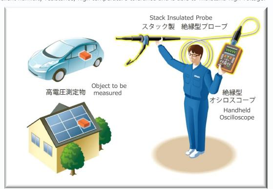
※プローブ黄色線は絶縁部分。被測定物及び測定機器が大地から離れている場合、絶縁型プローブを使用しないと測定者の体を電流が流れ感電する恐れがあります。また、被測定物のアースが取れていない状態で、接地型の測定器を使うと、絶縁型プローブを使用していても、感電や計測機器等を破損してしまう可能性があるので絶対に避けてください。
